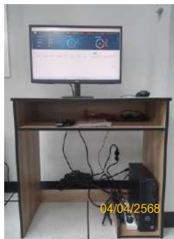
ภาพที่ 2-29 ระบบเก็บข้อมูลแสดงผลผ่านหน้าจอคอมพิวเตอร์จากแผงเซลล์แสงอาทิตย์
